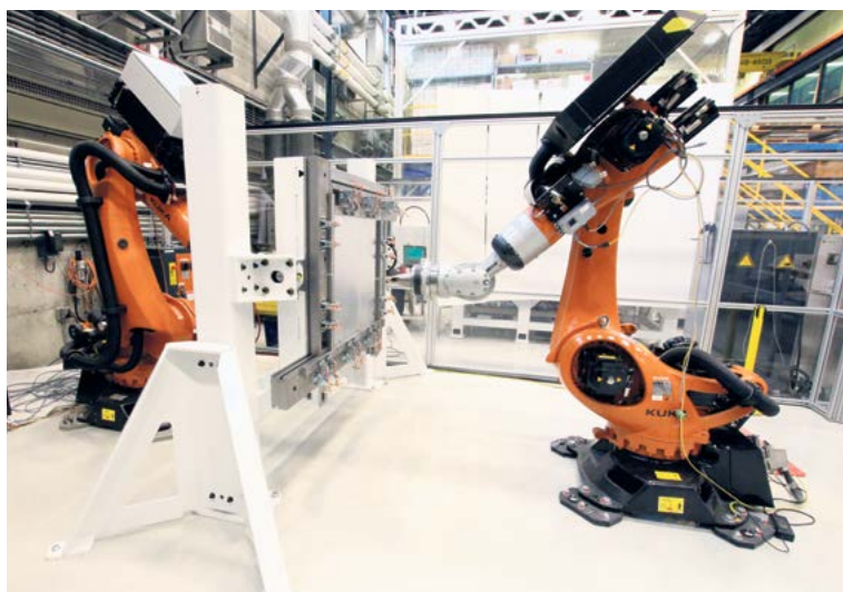
Cellule robotique utilisée pour la mise en forme rapide de pièces en aluminium au CNRC.
