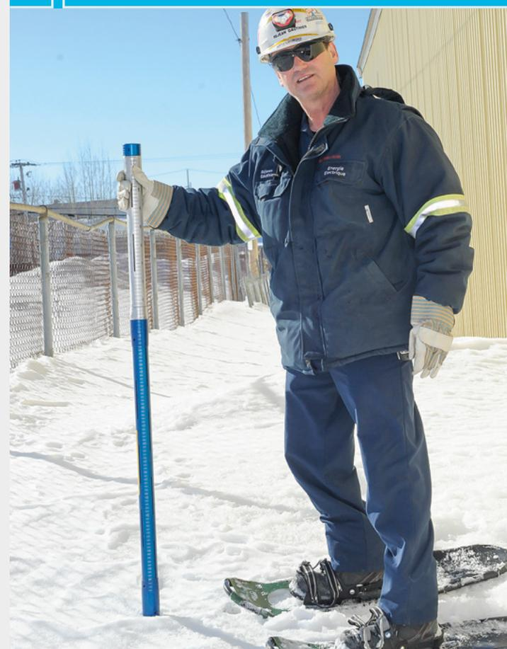
**2** L'échantillon est pesé à l'aide d'un outil spécial qui détermine l'équivalent en eau.
