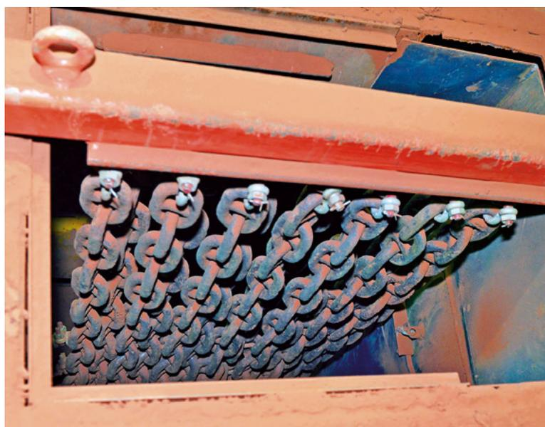
L'équipe de mécaniciens a recyclé les chaînes d'amarrage des remorqueurs afin de les installer dans les chutes.
