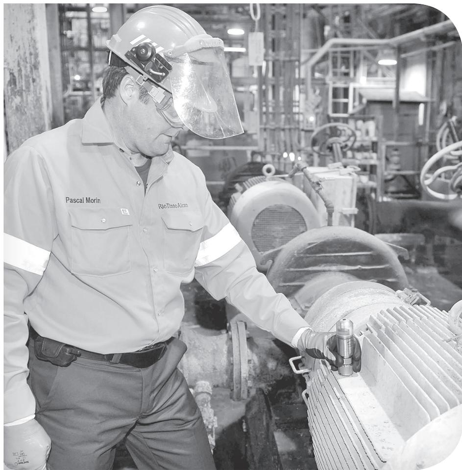
L'USINE VAUDREUIL EST DÉSORMAIS ÉQUIPÉE DE TRANSMETTEURS DE VIBRATIONS SANS FIL POUR SUIVRE, EN TEMPS RÉEL, L'ÉTAT DE SES ÉQUIPEMENTS AFIN D'ÉVITER DES BRIS ET DES PERTES DE PRODUCTION. IL S'AGIT DE LA PREMIÈRE USINE DE RIO TINTO ALCAN AU CANADA À UTILISER CE GENRE DE TECHNOLOGIE.
