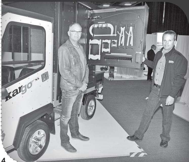
« Jamec en sont à la production de leur second atelier mobile, le premier ayant été fabriqué de façon artisanale. Dans le but d'augmenter la polyvalence de l'atelier, de se rapprocher des besoins des clients et de réduire les coûts de production, ils ont bâti cet atelier mobile avec des extrusions d'aluminium », explique Denis Giguère, directeur de projet au bureau de Développement économique régional.
