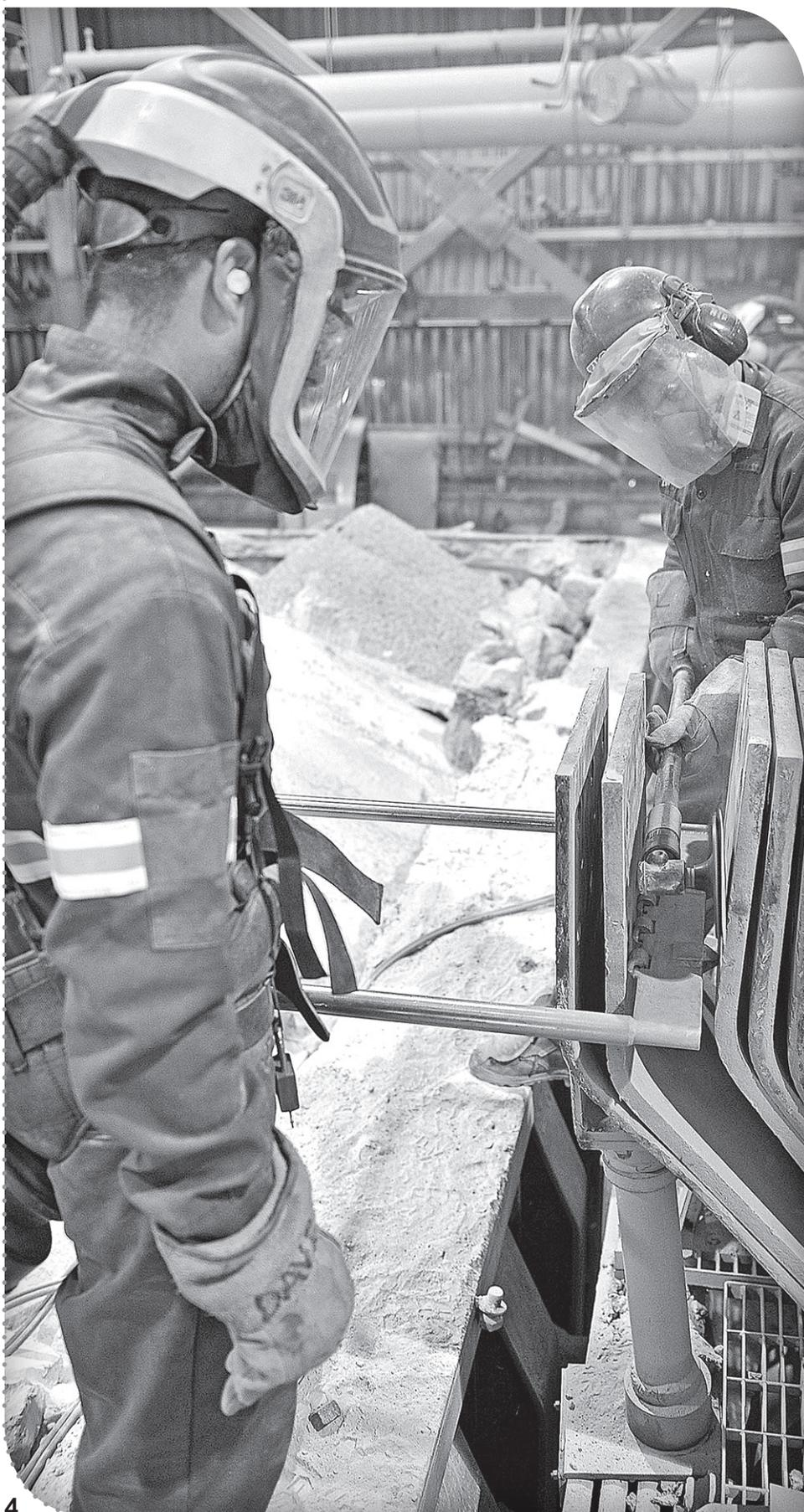
En 2011, les responsables du secteur ont constaté que la moyenne des chutes de tension des montées anodiques de l'ensemble de l'usine se situait à 38 millivolts alors que la cible à atteindre se situe plutôt entre 20 et 30 millivolts.
