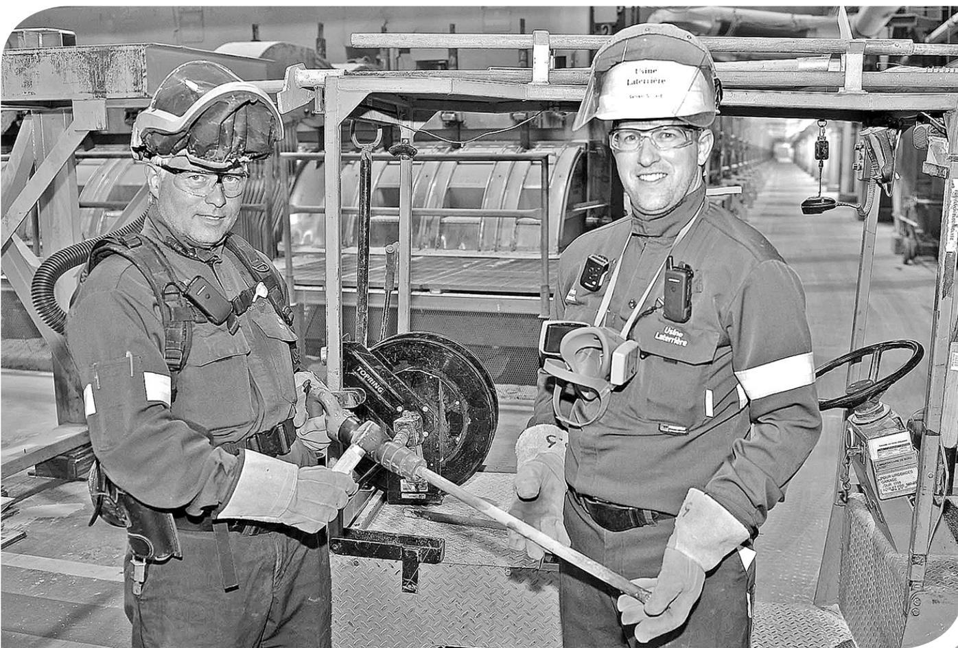
Auparavant, les opérateurs à l'Électrolyse devaient, pour percer la croûte qui se forme dans les cuves et prélever les échantillons, utiliser une barre de force et une masse. Après deux mois d'essais concluants, ils ont maintenant le choix d'utiliser le nouvel outil.
